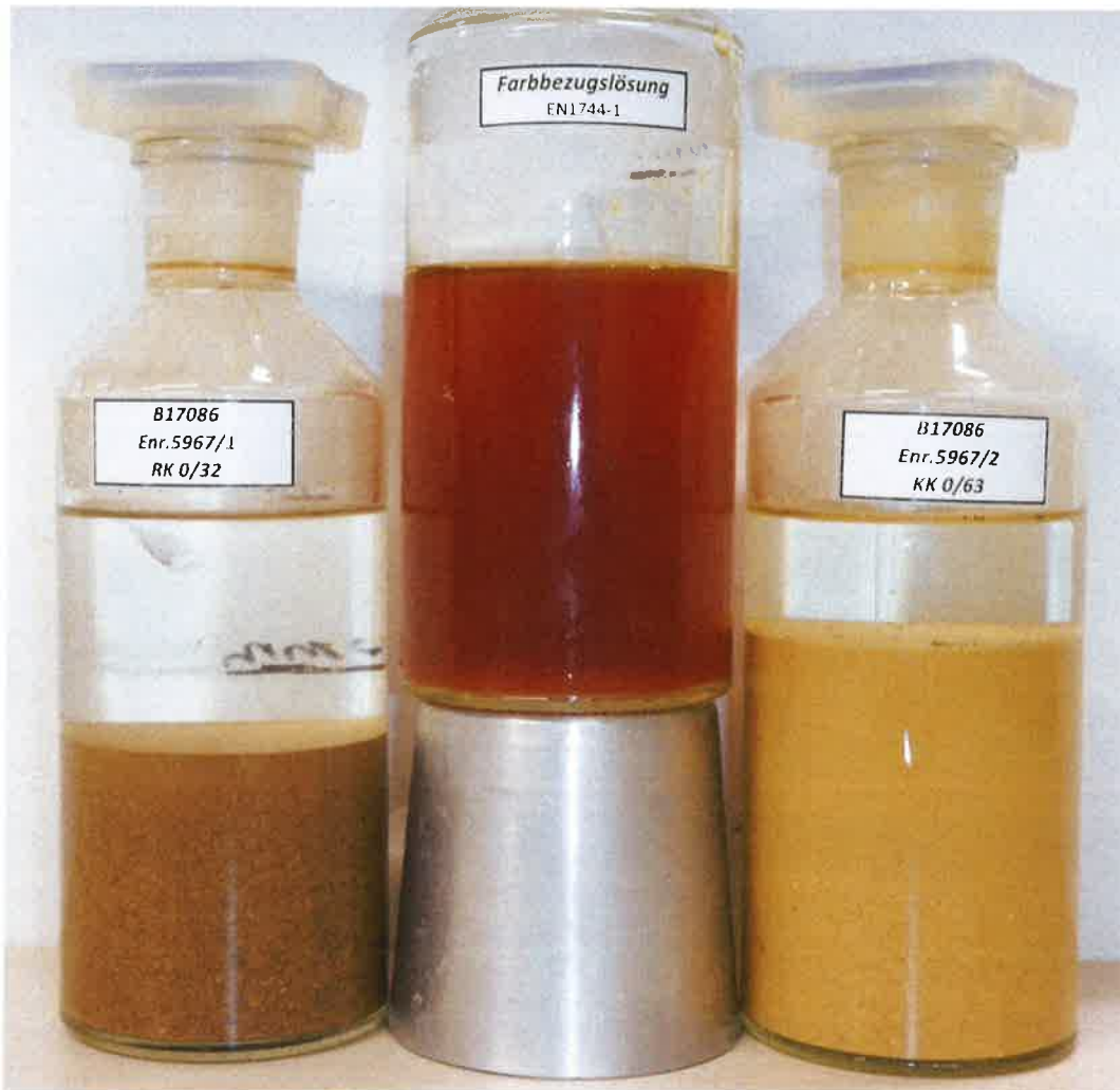
Abbildung A-1 : Prüfergebnis Humusgehalt gemäß ÖNORM EN 1744-1
